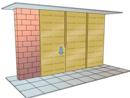
**E** Répéter l'opération et sceller les joints avec **Tecsound S50 Band 50** (si un chevauchement est installé).
