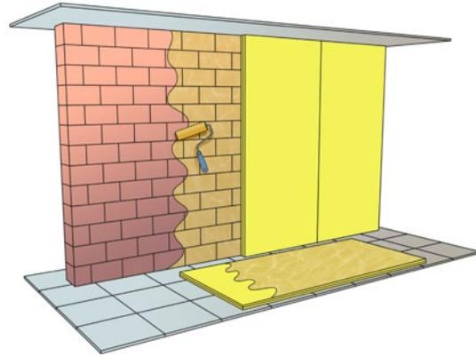
**B** Appliquer une colle contact sur le produit (côté feutre) et sur le support, selon les instructions du fabricant.
