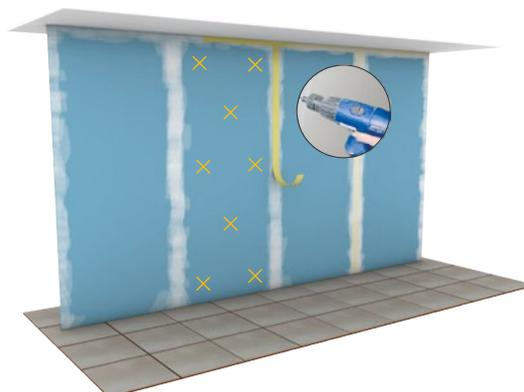
**C2** Visser la plaque de finition dans le cas d'un support non homogène, bois ou revêtu (papier peint, tapisserie, carrelage) ou hauteurs > 2,60m.
