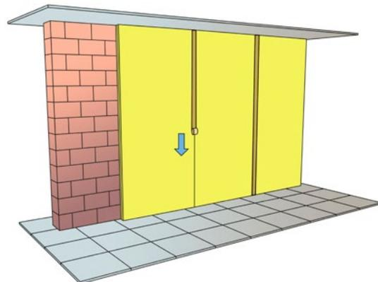
**D** Recouvrir 5 cm aussi bien à la verticale qu'à l'horizontale. Il faut toujours faire attention à coller correctement les joints, soit avec l'adhésif de contact soit avec des fixations. Dans le cas où le recouvrement des joints pourrait occasionner des problèmes de surépaisseur, au lieu de recouvrir la membrane, il faudra procéder au scellement du joint à l'aide des bandes type **Tecsound S50 Band 50**.
