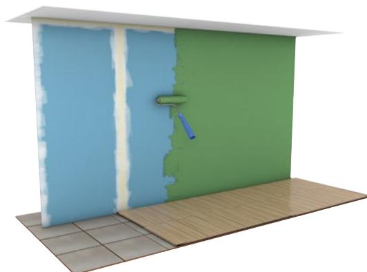
**D** Après pose des bandes de joints et du mastic, le support est prêt pour recevoir la finition.
