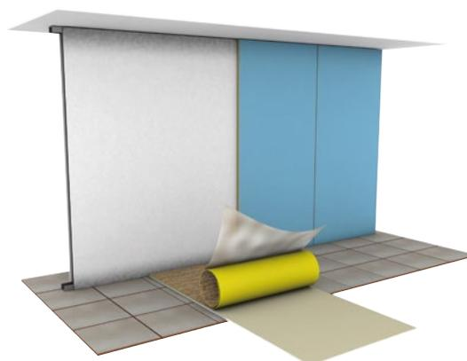
**B** Dérouler **Tecsound SY GEO** en enlevant le film siliconé détachable. La face adhésive se colle directement sur le dos de la plaque de plâtre.
