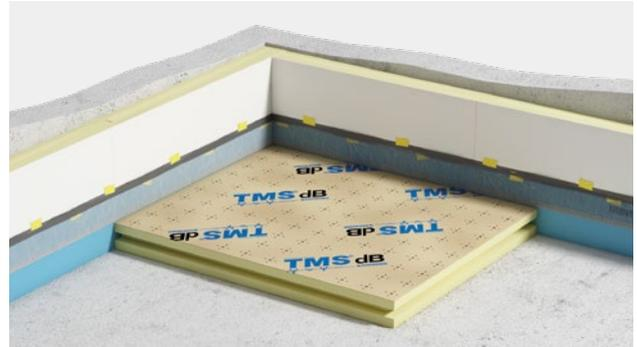
**B** Les panneaux **TMS® dB** sont ensuite posés en une seule épaisseur avec la face voile de verre au contact du support. La bande **Efirive** doit être scotchée ou agrafée sur la partie supérieure pour être maintenue sur la paroi. La pose de **TMS® dB** démarre dans l'angle du mur opposé à l'entrée de la pièce, avec les rainures d'emboîtement vers l'intérieur de la pièce.
