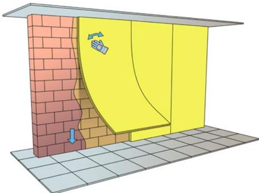
**C** Coller la membrane **Tecsound 2FT80** sur le support du côté du feutre et faire pression sur l'ensemble de la surface de la membrane afin d'éviter la formation de bulles d'air tout en s'assurant d'une adhérence correcte et totale.
