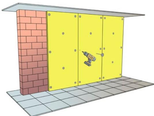
**E** Appliquer des fixations mécaniques pour tenir la membrane **Tecsound 2FT80** au support. Les fixations mécaniques doivent être du type **Fixation PT** à raison de 4 fixations/m<sup>2</sup> pour les murs et 5 fixations/m<sup>2</sup> pour les plafonds.
