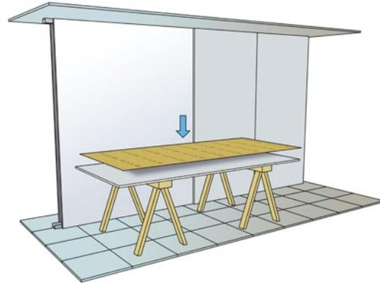
**B** Poser la membrane sur la plaque de plâtre en position horizontale avec le logo **TECSOUND** visible.
