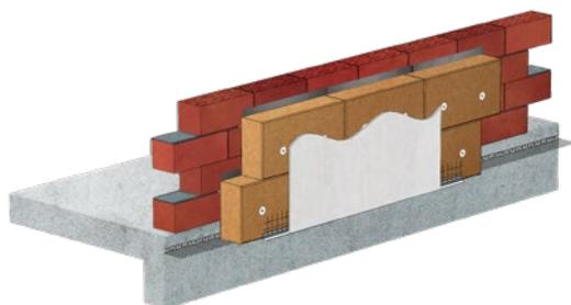
**H** Pose de la couche de base sur l'ensemble de la surface. Ajouter et maroufler la bande de trame dans la couche de base. Une fois la couche de base sèche, appliquer les enduits de finition.
