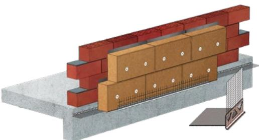
**G** Pose du profil de départ pré-entoilé par enfilage en force entre l'isolant et le profil de socle de départ PVC. Appliquer la couche d'enduit de base dans la zone pré-entoilée ainsi qu'au niveau des autres points singuliers.
