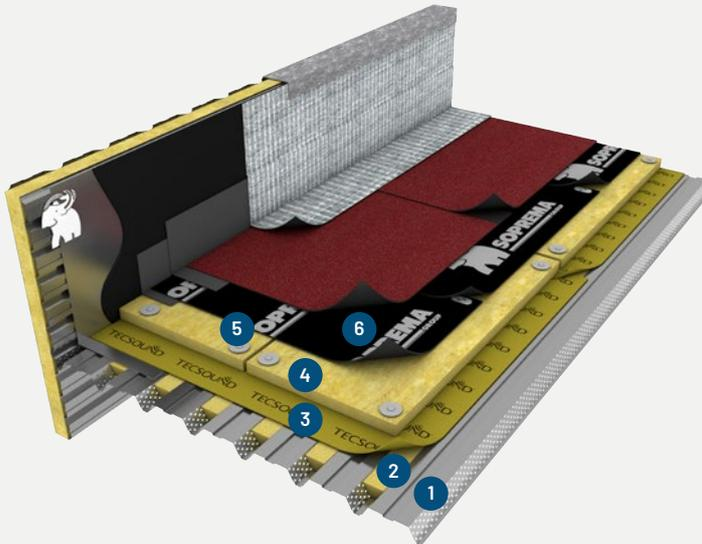
1 TAN 0,75 mm perforation sur flanc de nervuré
