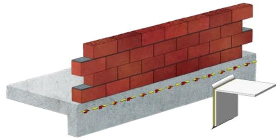
**B** Pose de petites équerres de positionnement d'une largeur de 5 cm, aidant au positionnement du futur profil.
