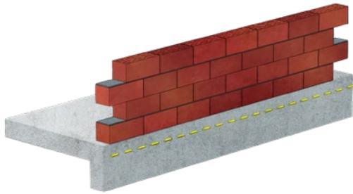
**A** Traçage de la position de départ sur le mur existant. Respecter une garde au sol de 20 cm par rapport au sol fini.
