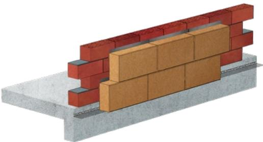
**E** Positionnement des panneaux **Pavawall®-Smart** après avoir appliqué la colle au dos. Il faut ensuite 24 heures de séchage.
