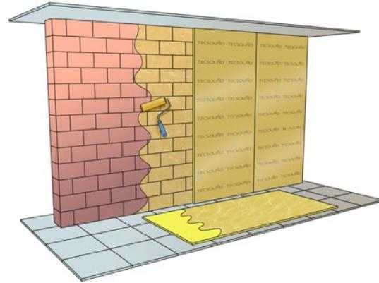
**B** Appliquer la colle contact sur le support et sur la face feutre du **Tecsound FT**.
