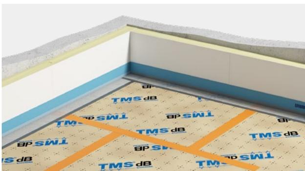
**E** Le rabat auto-adhésif de la bande **Efirive** permet le recouvrement des panneaux **TMS® dB** pour une fonction d'étanchéité afin d'éviter l'infiltration de la laitance.
