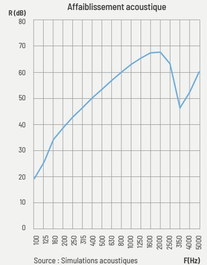
— Cloison 98/48 avec Pavacell dB®
