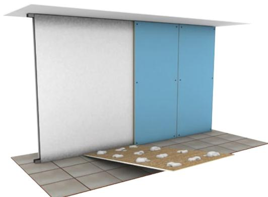
**C1** Appliquer des plots de mortier colle au dos de la membrane **Tecsound SY GEO**.
