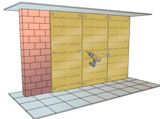
**D** En option, le **Tecsound FT** peut également se fixer mécaniquement par des fixations PT-H. Utilisation de 4 unités/m<sup>2</sup>.
