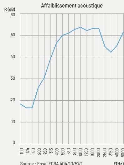
— Cloison 72/48 avec Pavacell dB®
