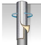
Enveloppez le conduit avec le feutre en contact avec la surface du conduit.
