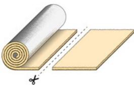
Mesurer la longueur du conduit à isoler en ajoutant 5 cm pour le recouvrement.
