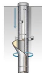
Sceller les joints à l'aide d'un ruban adhésif. S'assurer que les assemblages soient bien scellés afin de garantir une bonne isolation.
