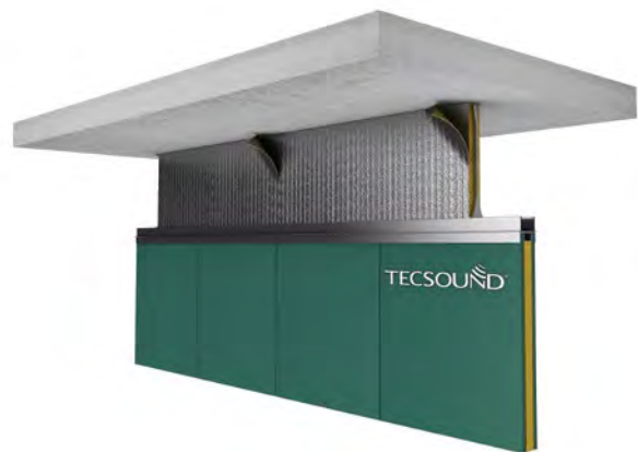
D Rajout de la membrane Easy MASS/Light sur le panneau Tecsound BARRIER .
