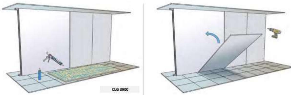
Pour appliquer le **Tecsound CLG 3900** en mastic-colle, déposez-le sur le panneau, puis positionnez l'ensemble sur la surface souhaitée. Exercez ensuite une pression ferme pendant 10 à 20 secondes afin d'assurer une adhérence optimale au support.
