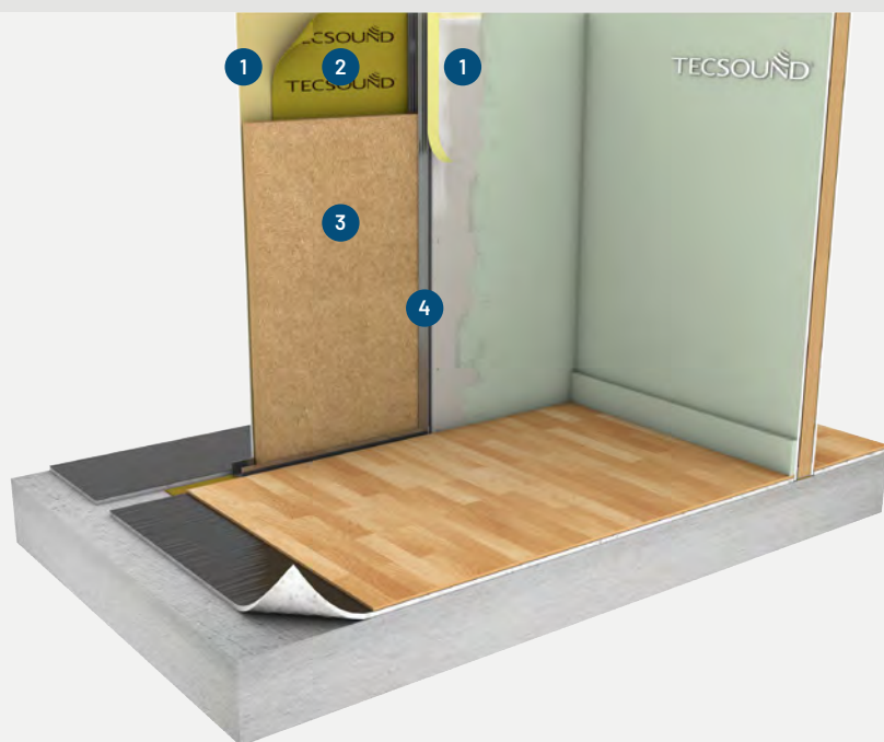
1 Plaque de plâtre 2 Tecsound SY 3 Pavaflex Confort 4 Montants et rails
